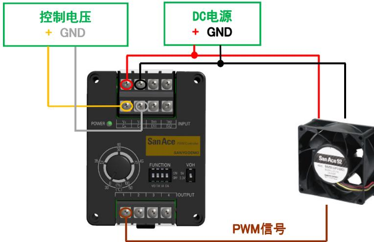
0V~5V的DC电压控制输出Duty
